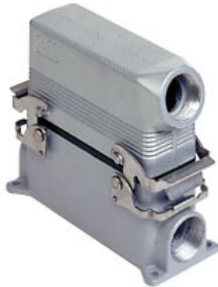
Connettore completo, serie CNZ, composto da 2 frutti con connessione con morsetto a vite 24 poli + PE, e custodia da parete con 2 leve e custodia mobile con ingresso cavo orizzontale
